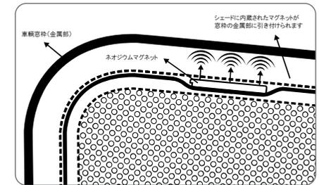
図2 取付概要(マグネットの埋め込み位置と効果)
